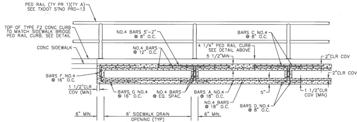
**CONC SIDEWALK BRIDGE ELEVATION VIEW**
