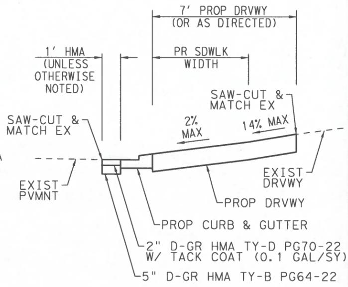
**PROP CURB & GUTTER DETAIL**
