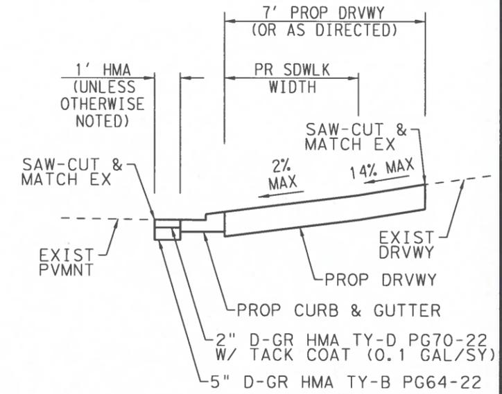
PROP CURB & GUTTER DETAIL
