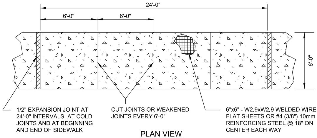
PREMOLD ASPHALTIC EXPANSION JOINT FILLER
